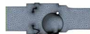
Рис. 4 – Конечно-элементная сетка проточной части резьбового клапана КТЗ-15 с шариковым затвором, состоящая из 537 441 узла и 1 936 424 элементов
